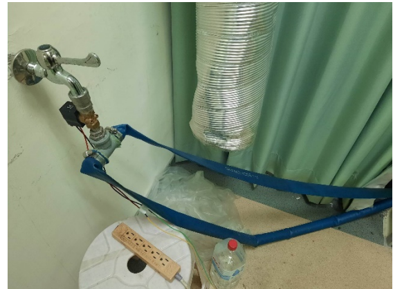
圖14、由電磁閥控制開關水土
